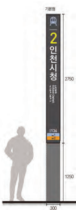
지하철안내표지 외부 지주형사인 (인천도시철도 1호선 통합안내사인 표준디자인)
