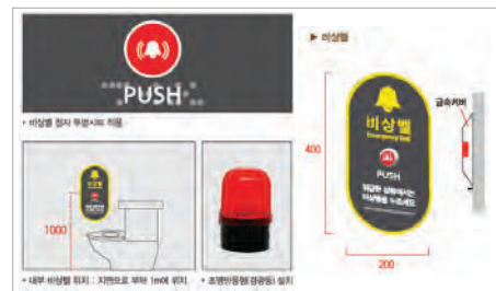
화장실 범죄예방 비상벨 설치(인천광역시 표준디자인)
