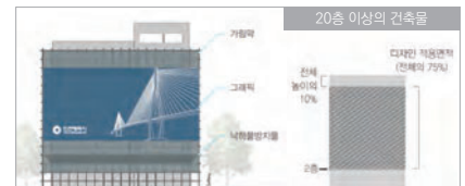
가설가림막 설치(인천광역시 표준디자인 매뉴얼)
