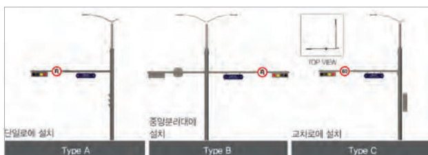
도로 유형 및 폭에 따른 통합지주 설치
